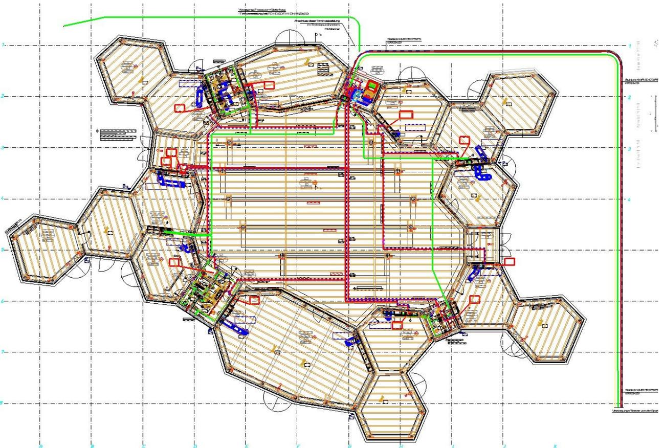
Die Sporthalle wird durch Deckenstrahlplatten und die Lüftung beheizt und gekühlt. Im Erdgeschoss befinden sich Dusch- und Sanitärräume.
